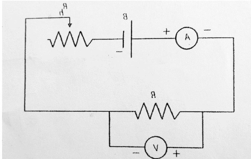
عند توصيل مقاومتين أو أكثر على التوالي يمر في جميعها نفس التيار الكهربائي أي يبقى التيار ثابتا بينما يتوزع الجهد الذي ينتجه المولد عليها بحسب قيمة كل مقاومة فالمقاومة الأكبر تستهلك جهدا أكبر بحيث يمكن إستبدال جميع المقاومات بمقاومة مكافئة  $R_s$  قيمتها تساوي قيمة مجموع المقاومات الموصولة على التوالي وتستهلك جهدا يساوي الجهد الكلي الذي ينتجه المولد
