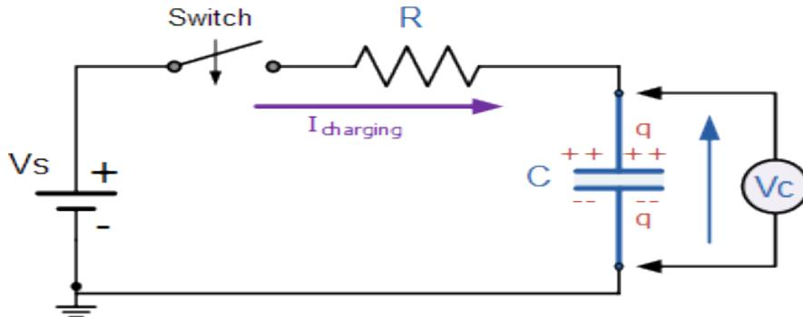
**المكثف الكهربائي** هو عبارة عن عنصر كهربائي يستخدم لتخزين الطاقة الكهربائية.
