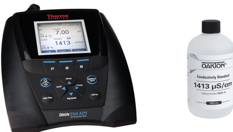
\* صورة توضيحية لجهاز pH Meter بإمكانه قياس الـ Conductivity .
