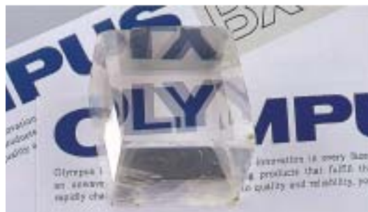
● Fig. 1.5a. Double refraction phenomenon due to calcite ●
