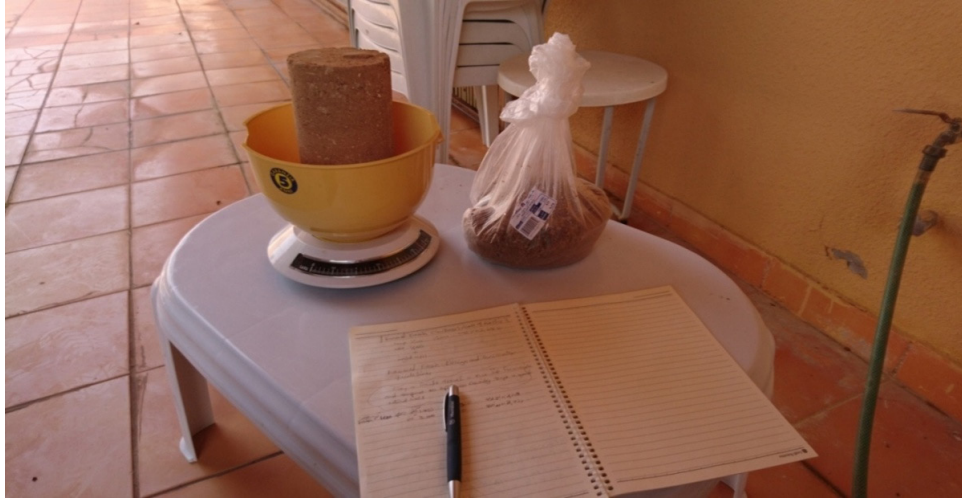
الشكل رقم (١٥). يتضح في الصورة المقابلة طريقة حساب كثافة التربة بعد الدك والتي تمثل الوزن مقسوماً على الحجم.
